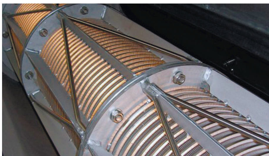
Рис. 4. Обезвоживающие барабаны шнекового пресса с фиксированным полотном
