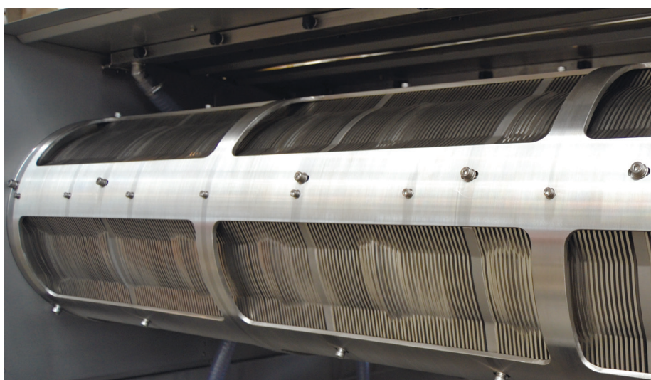
Рис. 2. Обезвоживающие барабаны мультидискового дегидратора
